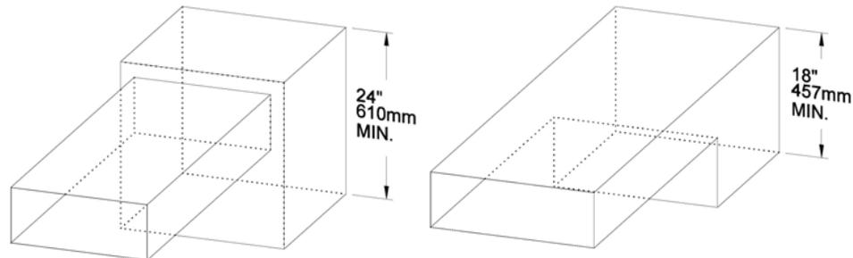
**Hauteur minimale de la sortie d'air chaud.**
