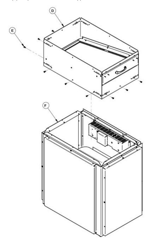
**Étape 4**: Installez les boulons élévateurs (H), fournis avec le manuel d'instructions, sous le boîtier du ventilateur dans les trous prévus à cet effet. Sécurisez le boîtier du ventilateur (D) à la fournaise à l'aide des vis (G) que vous avez conservées à l'**Étape 2**. Mettez votre ventilateur au niveau à l'aide des boulons élévateurs.
