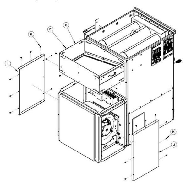
Installez ensuite l'option de plénum d'air froid PA08505 (6). Les instructions d'assemblage pour celui-ci se trouvent avec l'ensemble vendu séparément.
