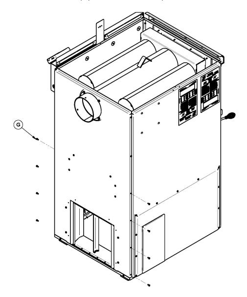
**Étape 3 :** Dévissez les vis (E) qui servent à sécuriser le support de conduit (D) au boîtier du ventilateur (F) tel qu'illustré. Retirez le support de conduit. Réservez.
